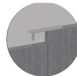
Système de liaison entre les panneaux rectangulaires
